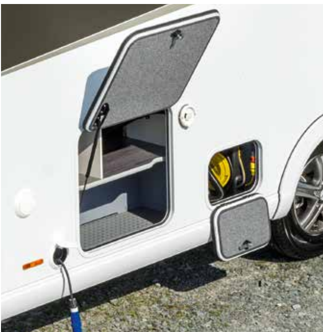
Automatisk kabelvinda med 15 m kabel och centralförsörjning
