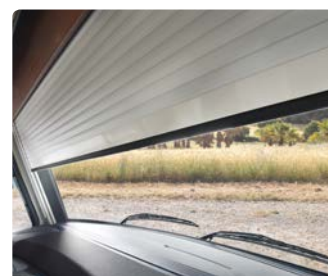
79117 Isolerande frontjalusi av aluminium, elektriskt manövrerad
