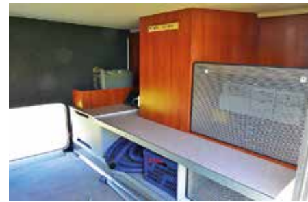
▲ Garaget är stort och inrett med lastskenor, hyllor, en plats för den extra toakassetten (!) och här finns även elcentral och batterier. Det är två luckor, bra, men bara en fullstor. ▼
